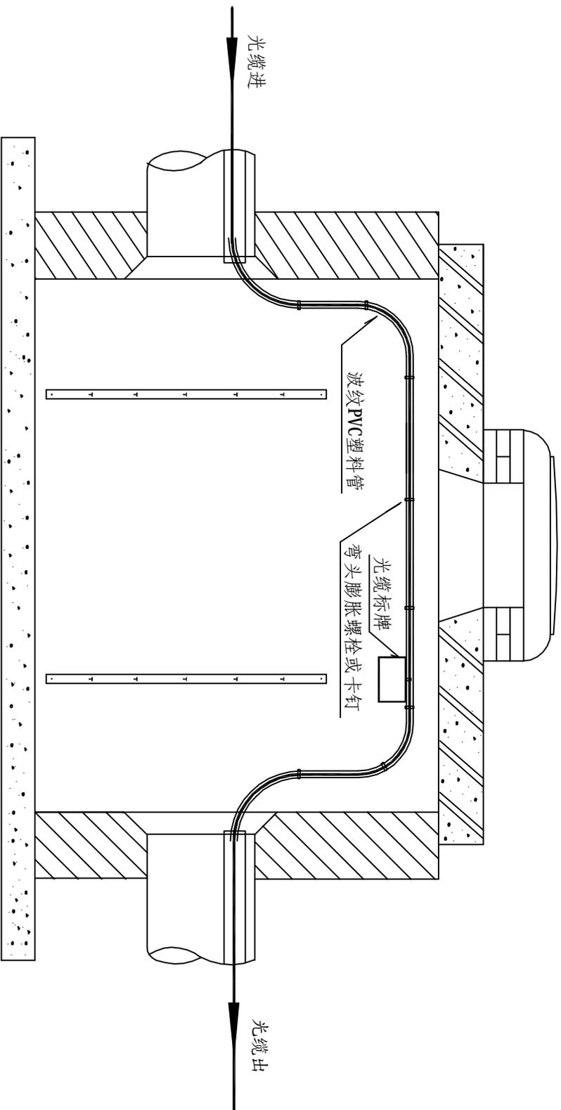
图1: 人手孔内光缆安装方式图
